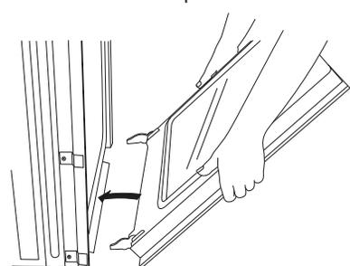
Saisir les bords de la porte du four avec les deux mains. Insérer les charnières en même temps et pousser la porte du four dans les fentes de la cavité du four pour la réinstaller. Si nécessaire, basculer doucement la porte d'un côté et de l'autre en la poussant.
