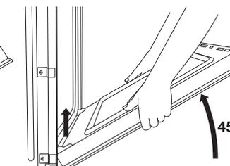
Saisir les bords de la porte du four avec les deux mains. Fermer la porte du four légèrement dépassé la position d'arrêt pour réduire la charge supportée par les loquets, puis tirer la porte de four vers le haut.
