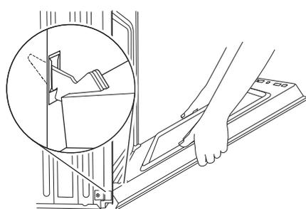
S'assurer que les encoches de charnière de la porte sont engagées au fond des fentes de la cavité du four.
