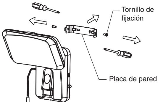
2. Utilice dos tornillos y anclajes para montar la placa de pared a una superficie sólida. Esté seguro que haya suficiente espacio vertical por encima de la placa de montaje que permita montar la lámpara.
