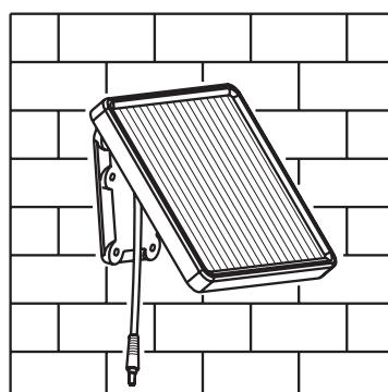
3. Acheminer soigneusement le câble du panneau solaire à l'appareil d'éclairage. Branchez le câble du panneau solaire dans la prise du câble qui sort du côté du boîtier de la pile.
