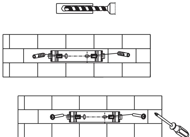
3. Faites glisser l'arrière du boîtier de la pile dans le support mural. Remettez les vis de blocage en place dans les côtés du boîtier de la pile.
