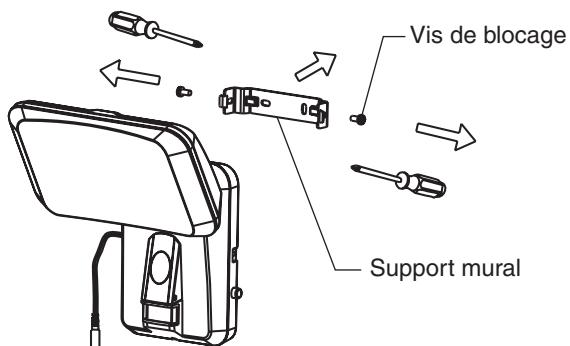
2. Fixez le support mural à une surface solide au moyen de deux vis et deux ancrages. S'assurer qu'il y a suffisamment d'espace vertical au-dessus de la plaque de montage pour monter l'éclairage.
