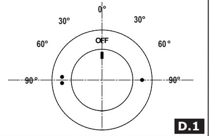
Flow rate information for 3-way valve • Información de intensidad de flujo para válvula de 3 vías
