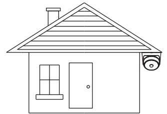
Montaje del alero
