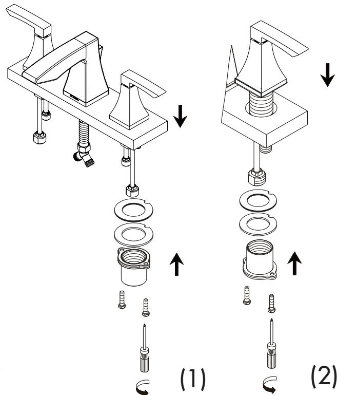
Mettre le corps de la manette dans l'orifice droit. Rassembler le petit matériel de fixation sur la tige du robinet ; utiliser un tournevis Phillips pour serrer à la toute fin, lorsque la manette est bien centrée.
