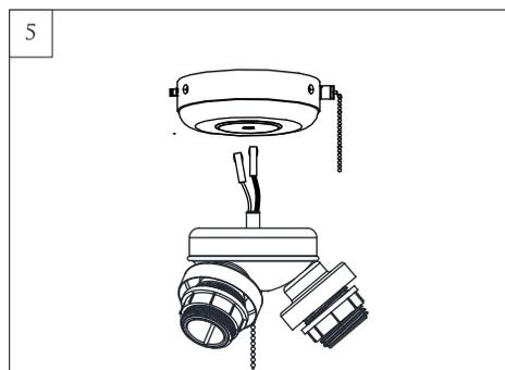
Faites passer les fils conducteurs du luminaire à travers le trou central situé dans le bâti à commutateur. Installez le bâti à commutateur sur le luminaire en tournant dans le sens horaire jusqu'à serrage complet.
