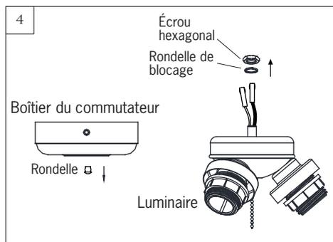
Retirez la découpe située dans le bas du bâti à commutateur. Retirez l'écrou hexagonal et la rondelle de blocage du luminaire. Conservez l'écrou hexagonal et la rondelle de blocage.
