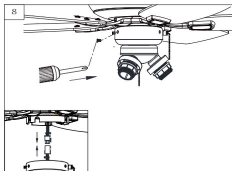
Si le câblage possède des prises, branchez la prise du ventilateur à celle de l'assemblage de la trousse d'éclairage. Assurez-vous que les prises sont pincées fermement. Installez l'assemblage de la trousse d'éclairage (boîtier du commutateur) sur le ventilateur avec les vis retirées à l'étape 2.
