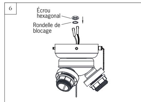
Placez la rondelle de blocage et l'écrou hexagonal sur les fils conducteurs du luminaire. Serrez fermement avec la tige filetée du luminaire.
