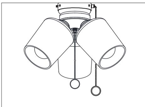
Installez 3 ampoules DEL de 9 watts de type encastré, et base moyenne.
