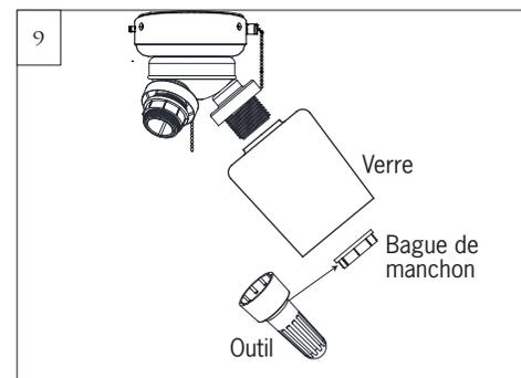
Dévissez la bague de manchon, puis positionnez le verre et verrouillez la bague de manchon à l'aide de l'outil fourni à cet effet.
