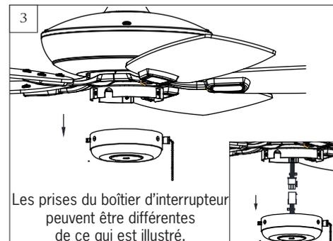
Débranchez (si le câblage a des connecteurs « Quick ») et enlevez le boîtier du commutateur du ventilateur.
