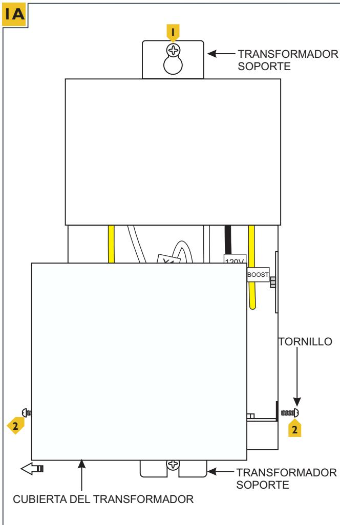
**NOTE:** NOTA: Para utilizar pequeños cables de calibre desde el transformador hasta la caja eléctrica, se recomienda instalar el transformador remoto cerca (si es posible) de la caja eléctrica. Consulte "Tamaño del cable de bajo voltaje Tabla" a continuación.
