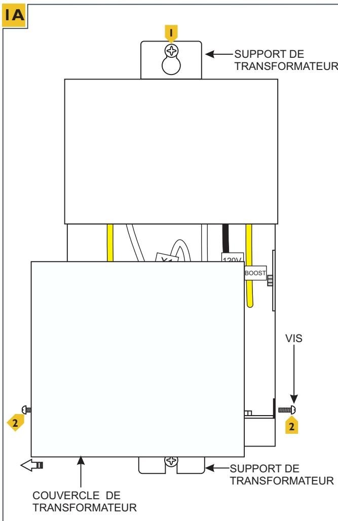
**NOTE:** Pour utiliser les petits fils de jauge du transformateur à la boîte électrique, il est recommandé d'installer le transformateur à distance proche (si possible) de la boîte électrique. Voir "Taille Basse Tension Fil tableau" ci-dessous.
