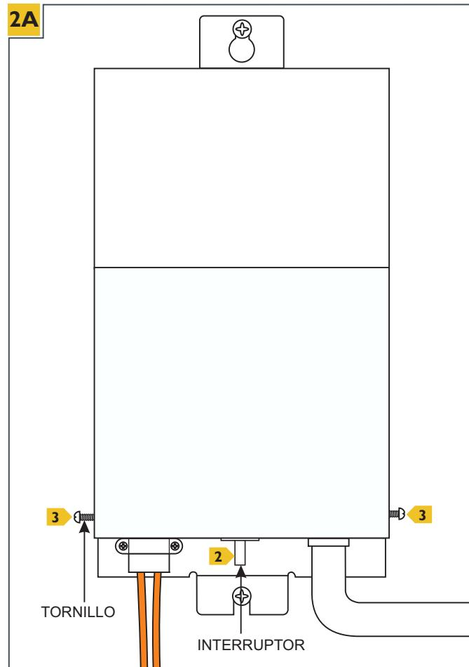
**7** Instale un conector de conducto y llevar a los cables del conector de baja tensión de la lámpara al transformador remoto.
