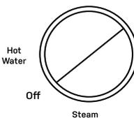
**REMARQUE :** Assurez-vous que le bouton est en position Off lors de la mise sous tension de la machine. La fonction d'infusion ne sera disponible que si le bouton est en position neutre au démarrage.
