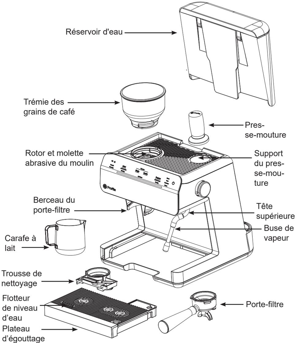
**REMARQUE :** Lorsque le flotteur de niveau d'eau atteint le dessus du plateau d'égouttage, retirez le plateau et jetez le liquide. Remplacez-le dans l'appareil avant la prochaine utilisation.
