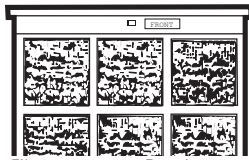
Filtre encrassé – Requiert un nettoyage
