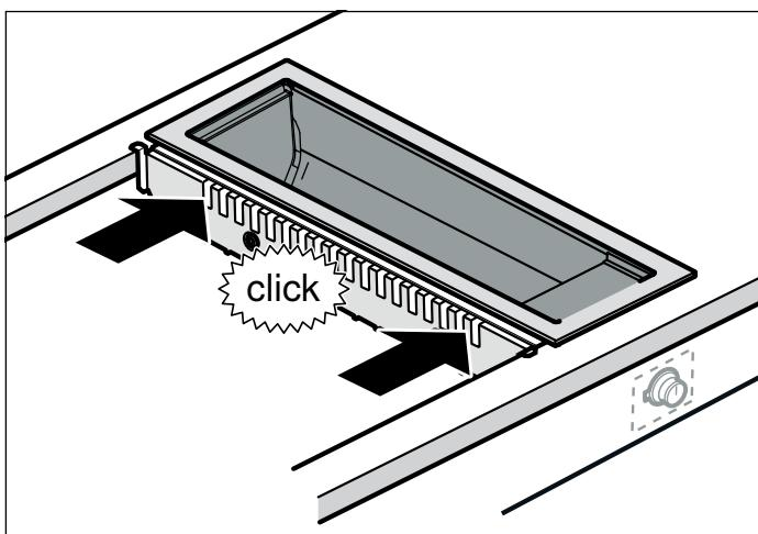
5. Installez les autres appareils et les barrettes de raccordement.
