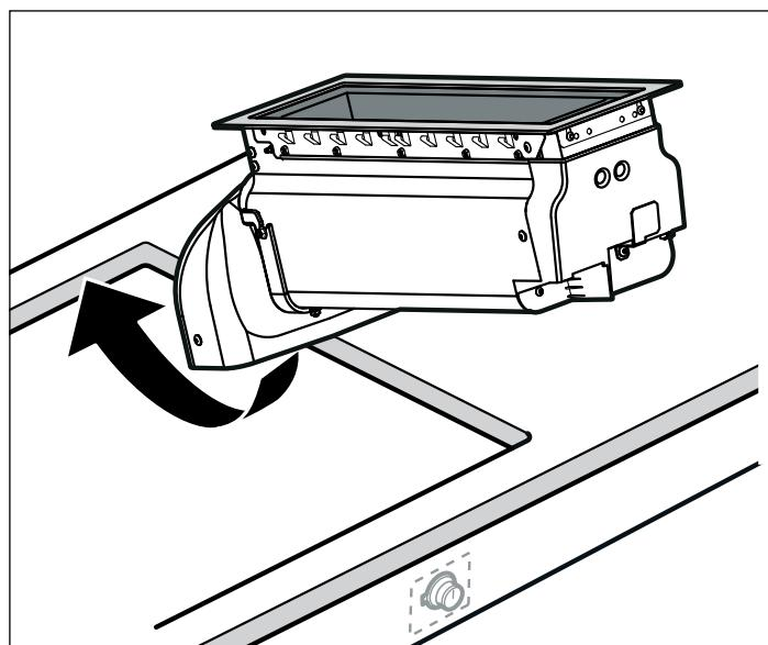
3. Colocar la junta de unión VA 420 000/010 (accesorio de montaje) en la cavidad de la cubierta.
