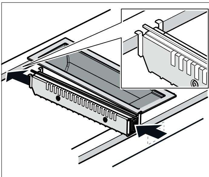
4. Poussez la barrette de raccordement fermement sur l'appareil, poussez les ressorts de serrage de l'appareil de manière audible dans les évidements au niveau de la barrette de raccordement.
