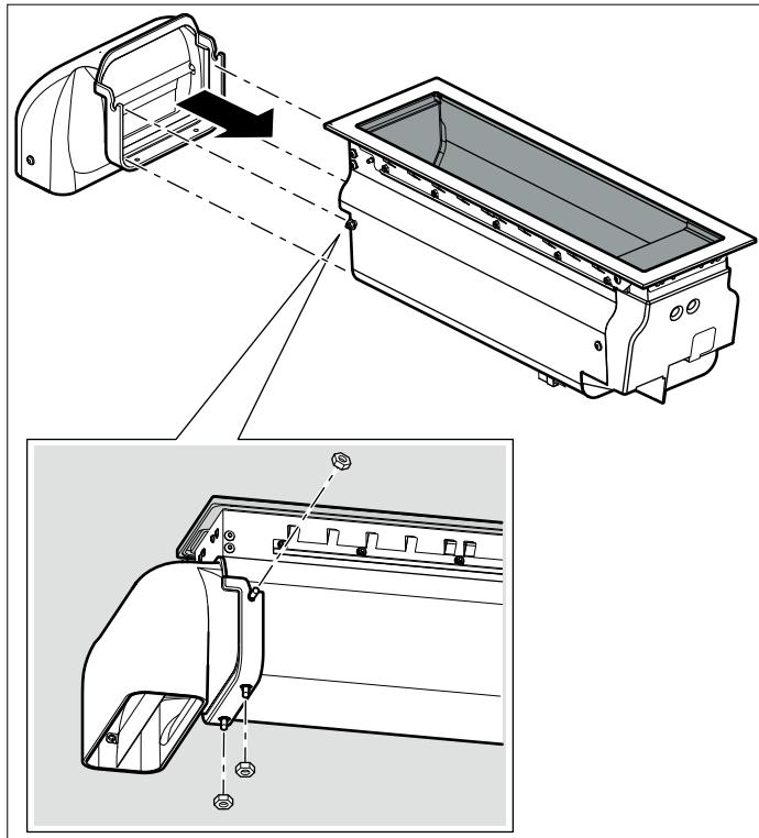
2. Insérez l'aérateur de plan de cuisson dans la découpe du plan de travail.
