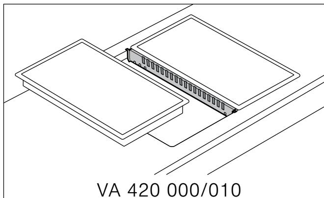
Les appareils peuvent également être installés dans des découpes séparées, en respectant une distance minimale de 2" (51 mm).
