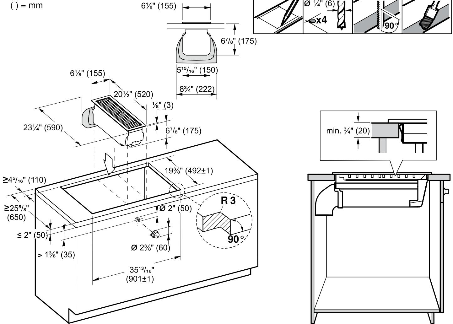
**Montaje a ras de superficie:** El aparato se puede montar en las siguientes encimeras resistentes a la temperatura y al agua:
