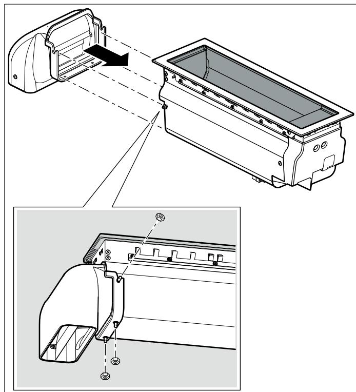
2. Colocar la ventilación para la placa de cocción en la cavidad de la cubierta.
