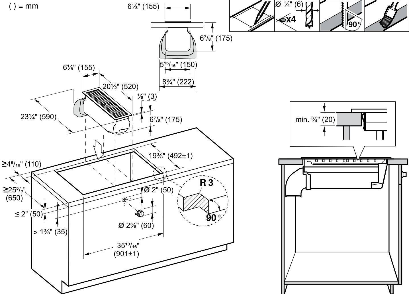
**Pose en affleurement:** L'appareil peut être encastré dans des plans de travail résistant à la chaleur et à l'eau, fabriqués dans les matériaux suivants :
