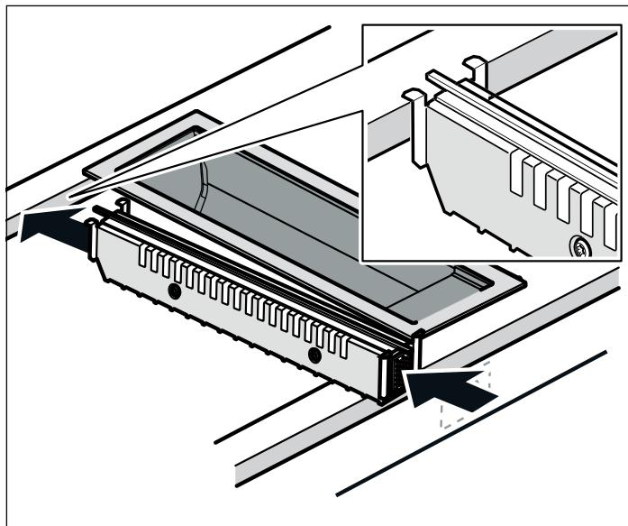
4. Presionar la junta de unión con fuerza contra el aparato hasta que los muelles antirrascar del aparato encajen de forma audible en las cavidades de dicha junta.
