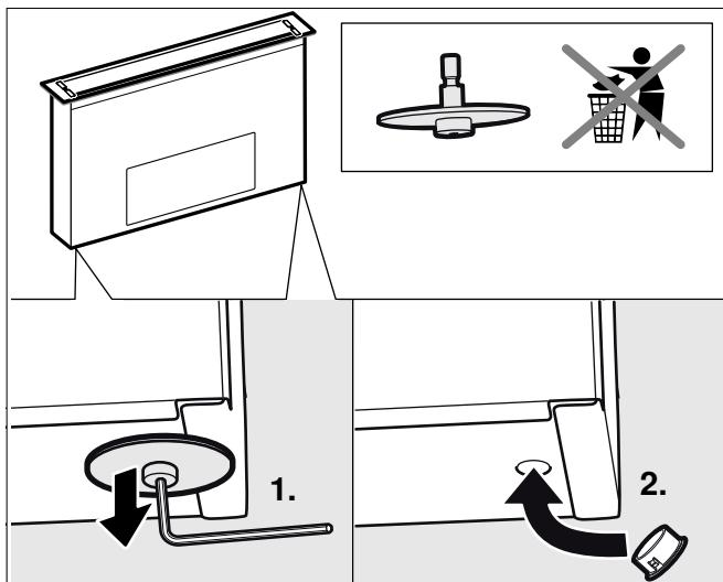
**Nota:** Guardar los seguros de transporte. Instalar nuevamente los seguros de transporte antes de transportar el aparato (por ejemplo, en una mudanza).
