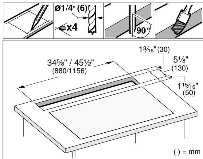
**Montaje a ras de superficie:** se puede realizar un montaje a ras de superficie de la encimera.
