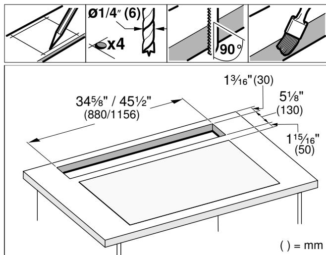
**Pose en affleurement:** L'appareil peut être posé en affleurement dans un plan de travail.
