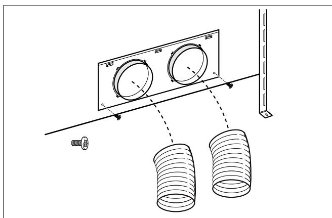
**Remarque :** En cas d'utilisation d'un tuyau en aluminium, lisser au préalable la zone de raccordement.
