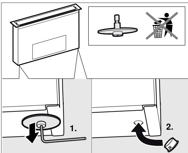
**Remarque :** Ranger les sécurités de transport. Remonter les sécurités de transport avant de transporter l'appareil (par ex. déménagement).
