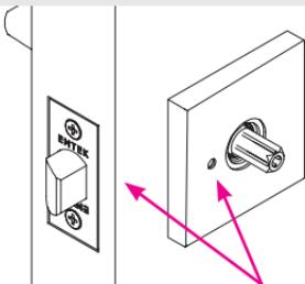
**A** En la función de privacidad, asegúrese de que el orificio del pasador de seguridad en la roseta esté en el lado más cercano al borde de la puerta y que esté alineado con el orificio del Mecanismo de CF.
