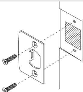
**Paso 3:** Sujete el pestillo con (2) de los tornillos para madera de tres cuartos de pulgada.
