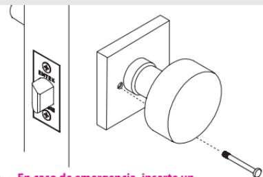
**A** En caso de emergencia, inserte un objeto con forma de clavo en el orificio de liberación de la roseta exterior, para abrir la cerradura.
