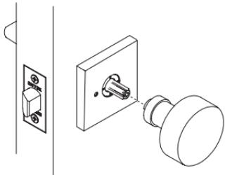
**Étape 5:** Serrez fermement la vis de réglage pré-installée dans le levier ou le bouton à l'aide de la clé Allen fournie. Assurez-vous qu'il est fermement serré.
