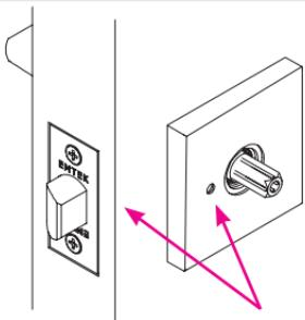
**NOTE:** Dans la fonction de sécurité, assurez-vous que le trou de le verrou de sécurité dans la rossette est du côté le plus proche du bord de la porte et s'aligne avec le trou dans le mécanisme CF.
