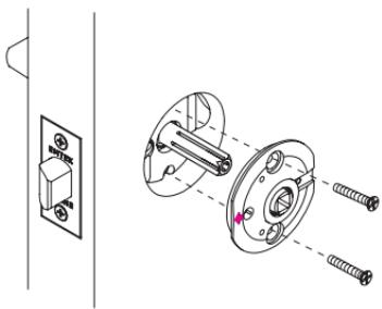
**⚠ NOTE: Assurez-vous que le trou de la Mécanisme de CF fermeture dissimulé est aligné avec le trou de la serrure de sécurité dans le Loquet.**
