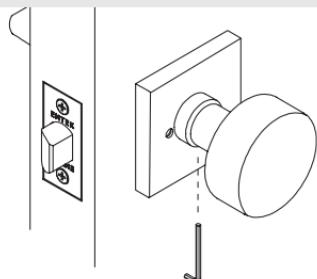
**Paso 6:** Atornille el pasador de seguridad a través de la roseta, en el pestillo. Para verificar la funcionalidad, gire la palanca o la perilla para enganchar el pestillo. Ahora, empuje el pasador de seguridad y gire la palanca o la perilla. La palanca o perilla no debe retraer el pestillo.
