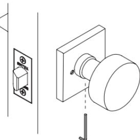
**Étape 6:** Visser le verrou de sécurité à travers la rossette, dans le loquet. Pour vérifier la fonctionnalité, tournez le levier ou le bouton pour engager le loquet. Maintenant, enfoncez le verrou de sécurité et tournez le levier ou le bouton. Le levier ou le bouton ne doit pas rétracter le loquet.
