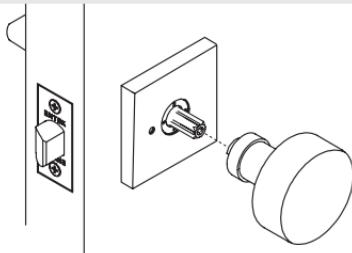
**Paso 5:** Ajuste firmemente el tornillo de fijación preinstalado en la palanca o la perilla, con la llave Allen suministrada. Asegúrese de que esté bien ajustado.
