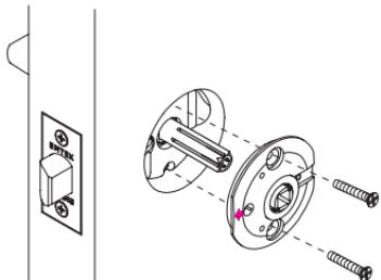
**! Asegúrese de que el orificio en la Mecanismo de CF esté alineado con el orificio del pasador de seguridad en el pestillo.**
