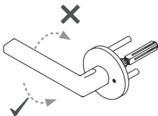
**Paso 1:** Monte la placa preensamblada, con el husillo entrando en el centro de la herramienta de alineación plástica.
