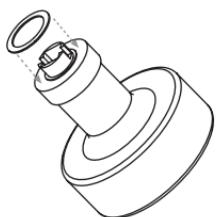
**Paso 4:** Deslice la palanca de la puerta o la perilla en el husillo. Asegúrese de que la arandela de plástico permanezca centrada en el vástago, a medida que desliza la palanca o la perilla hacia el husillo y contra la roseta.
