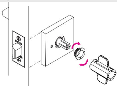
**Paso 3:** Coloque la arandela de plástico en la palanca de la puerta o la perilla.
