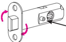
Si le loquet a une fonction de sécurité, le trou fileté de le verrou de sécurité doit faire face au côté intérieur de la porte.
