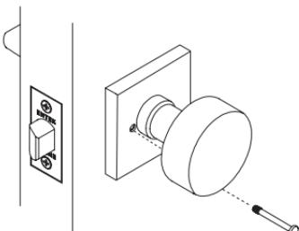
**A** Pour l'urgence, insérez un objet de type clou dans le trou de dégagement de la rossette extérieure pour ouvrir la serrure.
