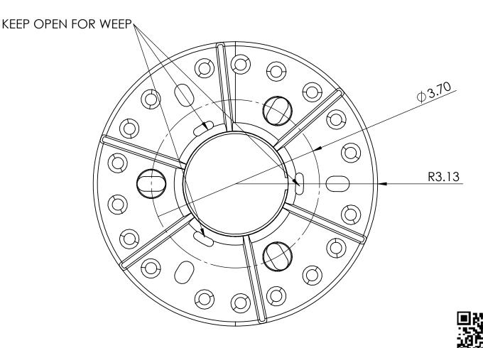
ONLY CONNECTS TO 3 BOLT CAST IRON DRAINS
