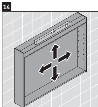
> Vérifiez que l'armoire soit nivelée et fixée au mur de façon sécuritaire.
