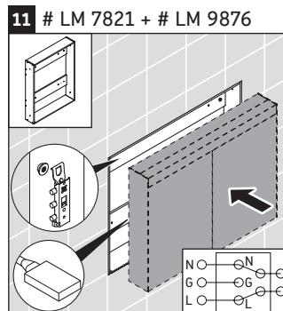
> Indiquez l'emplacement de la boîte de câblage à l'arrière de l'armoire. Faites un trou dans le mur pour y faire entrer la profondeur de cette boîte en plus des conduits électriques entrant dans la boîte. Veuillez consulter les instructions de câblage à la p. 16.
