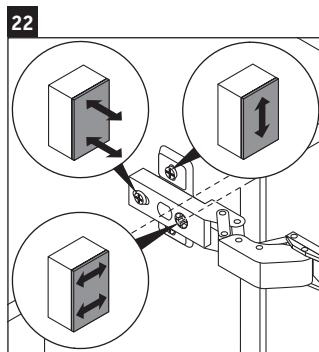
> Ces vis permettent un ajustement dans trois directions : de haut en bas, de l'avant à l'arrière et d'un côté à l'autre. Au besoin seulement, effectuez des ajustements mineurs à la ou aux façade(s) de l'armoire, fermez la porte pour vérifier l'alignement de chaque ajustement effectué.
