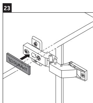
> Una vez completado el ajuste, sustituir la cubierta abatible.
