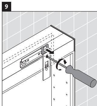
> Couchez le bas du miroir contre le mur et serrez la vis de fixation pour fixer le miroir en place.
