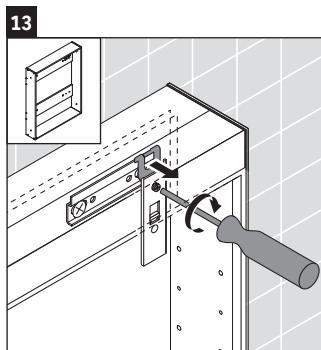
> La vis supérieure permet un ajustement de l'avant vers l'arrière.
