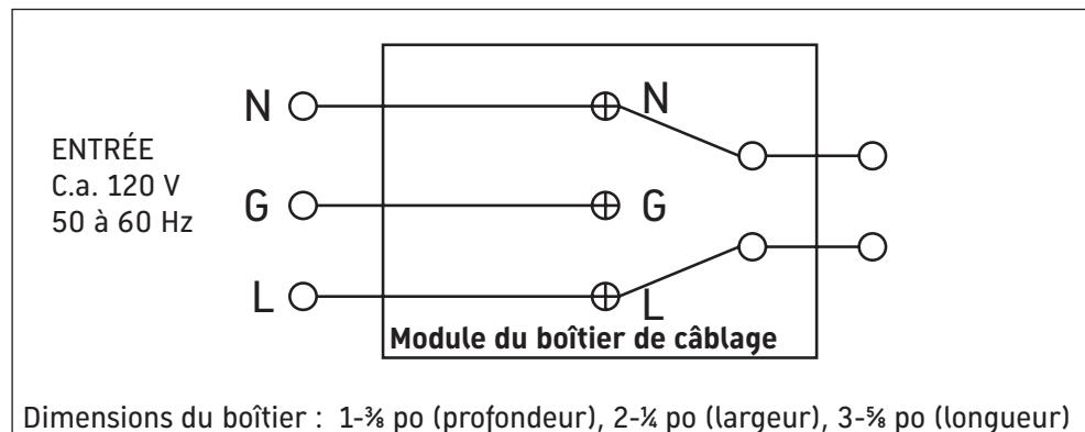
Dimensions du boîtier : 1-3/8 po (profondeur), 2-1/8 po (largeur), 3-5/8 po (longueur)
