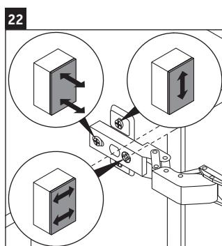
> Estos tornillos permiten ajustar en tres direcciones: arriba y abajo, desde delante hacia atrás y de lado a lado. Solo en caso necesario, realizar pequeños ajustes en el frontal o frontales del mueble. Para ello, cerrar la puerta y comprobar la alineación con cada ajuste.
