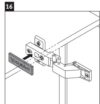
> Volver a fijar la placa con el logotipo de Duravit en la bisagra del espejo.
