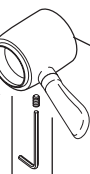
RP50465 Set Screw & Wrench Tornillo de Ajuste y Llave Vis de calage et Clé
