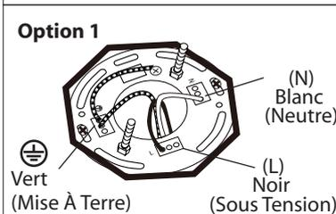
2. **Option 1:** Poussez pour brancher les fils de la boîte électrique (courant de la maison) dans les insertions appropriées.
