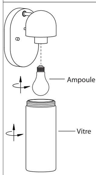
5. Vissez le verre sur le luminaire. Assurez-vous que le verre est attaché de façon sécuritaire au luminaire.
