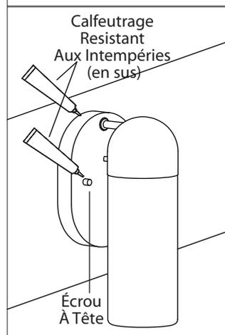
7. Après l'installation, scellez autour des périmètres du haut et des cotés avec un scellant contre les intempéries. Le dessous ne devrait pas être scellé pour prévenir une accumulation d'humidité. Appliquez une petite quantité de calfeutrage autour du périmètre entre l'écrou à capuchon et la plaque de montage.
