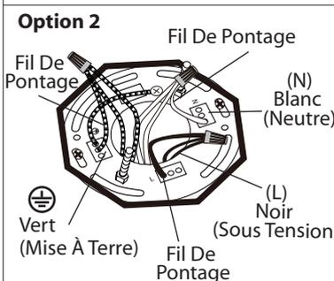
2. **Option 2:** Lorsqu'il y a des multiples de fils dans la boîte électrique, vert (mise à terre), noir (sous tension), blanc (neutre), poser seulement qu'un de chaque fil soit vert, noir et blanc avant pour la connexion. Retirez 7mm de la gaine d'un fil de pontage de 6" inclus. Posez (poussez) les fils dans les insertions appropriées.
