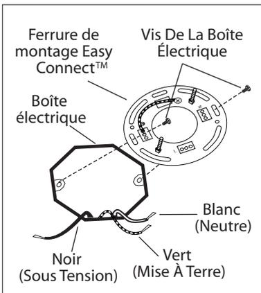
1. Posez la ferrure de montage Easy Connect™ à la boîte électrique à l'aide des vis de la boîte électrique (en sus).
