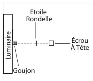
4. Poussez délicatement les fils à l'intérieur de la boîte électrique et placez le luminaire sur les goujons sur la ferrure de montage. Serrez le luminaire en place à l'aide des écrous étoilés et les écrous à capuchon.
