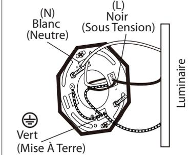
3. Branchez (poussez) les fils électriques du luminaire dans les insertions appropriées.
