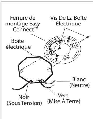
1. Posez la ferrure de montage Easy Connect™ à la boîte électrique à l'aide des vis de la boîte électrique (en sus).
