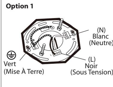
2. **Option 1:** Poussez pour brancher les fils de la boîte électrique (courant de la maison) dans les insertions appropriées.
