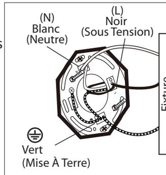
3. Branchez (poussez) les fils électriques du luminaire dans les insertions appropriées.
