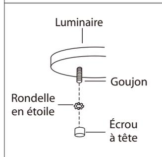
4. Poussez délicatement les fils à l'intérieur de la boîte électrique et placez le luminaire sur les goujons sur la ferrure de montage. Serrez le luminaire en place à l'aide des écrous étoilés et les écrous à capuchon.
