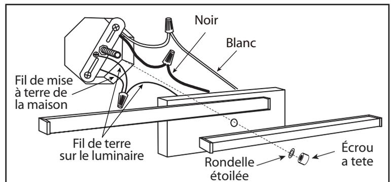
3. Branchez le fil de la mise à terre (cuivre nu ou vert) de votre montage au fil de la mise à terre (cuivre nu ou vert) ou vis de la mise a terre dans la boîte électrique. Posez le fil noir de la boîte électrique au deux fils noir de la fixture. Posez le fil blanc de la boîte électrique au deux fils blanc de la fixture.
