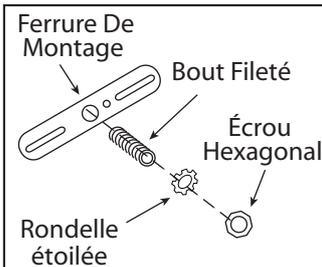
1. Posez le bout fileté à la ferrure de montage. Ajuster afin que le trou à l'arrière du luminaire soit dégagé et barrer en place à l'aide du bout fileté de la rondelle étoilée et l'écrou hexagonal.
