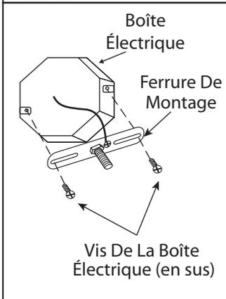
2. Posez la ferrure de montage à la boîte électrique à l'aide des vis (en sus).
