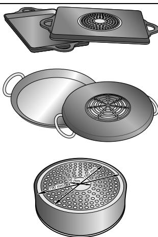
Al utilizar recipientes grandes con un área ferromagnética de diámetro más pequeño, se calienta únicamente la zona ferromagnética, de manera que la distribución de calor puede no ser homogénea.
