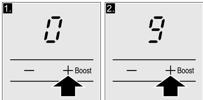
3. Para cambiar el nivel de potencia, pulse la tecla **+** o **-** hasta que se muestre el nivel de potencia deseado.
