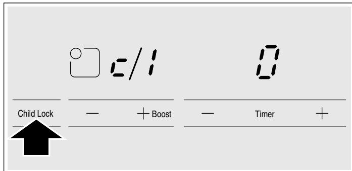
3. Pulse la tecla **Child Lock** hasta que se muestre el indicador para la función requerida.
