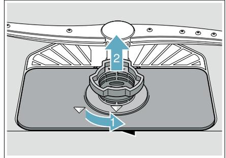
2. Retirez le microfiltre du filtre fin pour faciliter le nettoyage.
