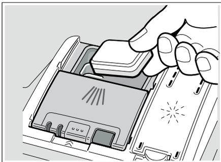
Ne versez du détergent que dans le distributeur de détergent sec [32]. Ajoutez le détergent. Ne remplissez pas le distributeur de détergent outre mesure.
