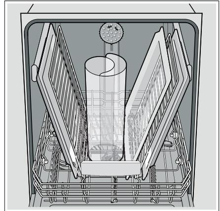
**Remarque :** L'orifice de ventilation [25] sur le côté gauche de la cuve à détergent doit être libre et pour cela, les articles de grande taille comme les planches à découper en plastique et les grandes plaques à pâtisserie doivent être placés au centre ou sur le côté droit du panier inférieur.
