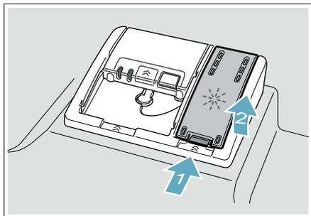
2. Ajoutez le produit de rinçage liquide au distributeur [31] à pleine capacité. Ne le remplissez pas outre mesure. Évitez tout déversement dans le trou d'aération.
