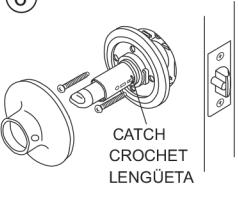
**6. Installation du mécanisme intérieur et du couvercle.**
