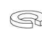
J x8 Lock washer \text{Ø}1/4'' \times \text{Ø}12 \times 3\text{mm} * x8 Rondelle de blocage \text{Ø}1/4'' \times \text{Ø}12 \times 3\text{mm} x8 Arandela de Seguridad \text{Ø}1/4'' \times \text{Ø}12 \times 3\text{mm}
