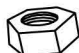
(T2) x8 Hex Nut Ø5/16" * x8 Écrou hexagonal Ø5/16" x8 Tuerca hexagon Ø5/16"
