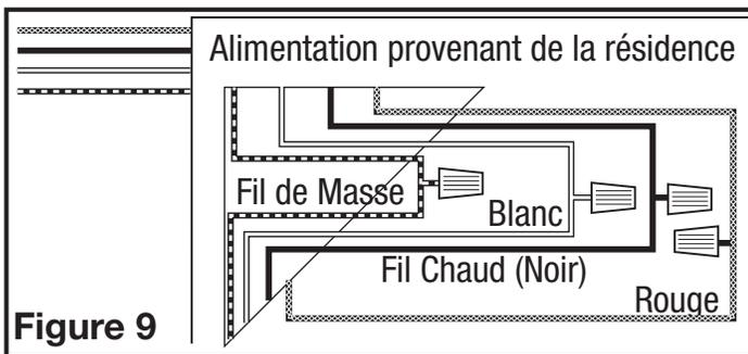
**REMARQUE :** les fils du réceptacle du ventilateur pourraient nécessiter d'être tirés à l'extérieur du compartiment pour le raccordement. Tirer uniquement les trois fils lâches à l'extérieur du compartiment. Des fils additionnels y sont présents.
