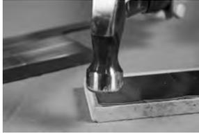
Utilisez un marteau pour redresser les bords. Placez la tuile coupée avec le bord courbé vers le haut sur une surface plane et rigide. Donnez des petits coups avec le marteau sur le bord courbé pour aplatir la courbature.
