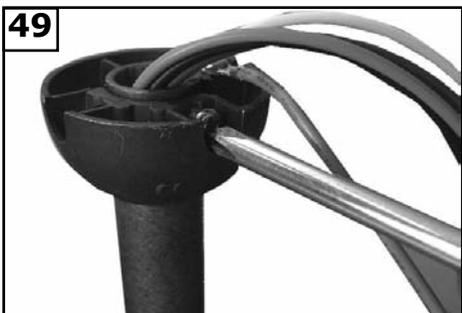
Remonter la fixation fermement contre l'épingle et bien serrer les vis dans la fixation. **Une vis desserrée pourrait amener le ventilateur à osciller.**
