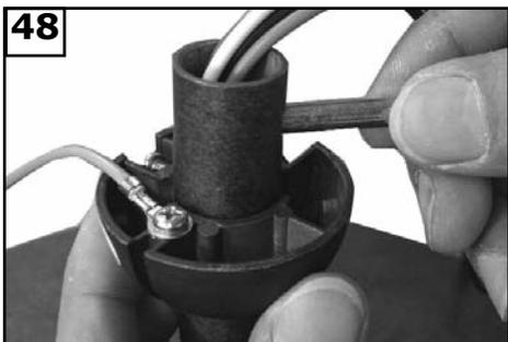
Passer l'épingle dans les deux orifices de la tige et placer la fixation de façon à ce que la tige soit bloquée dans la fente sur le haut de la fixation. **Remarque: L'Épingle doit être installée avec la tige et la fixation.**
