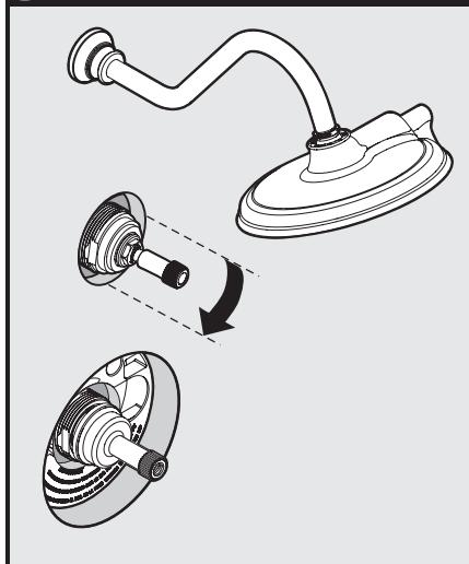
**8****Temperature Valve / Válvula de temperatura / Soupe de température**
