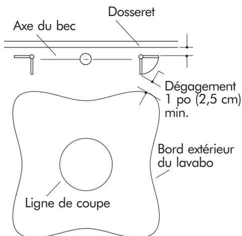
Découper l'ouverture, en suivant soigneusement la ligne tracée au crayon.
