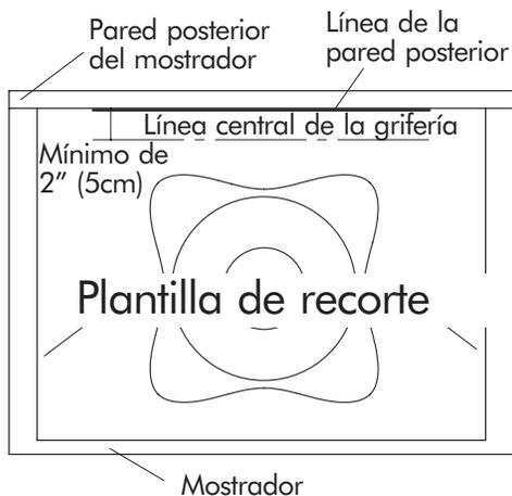
Corte la plantilla sobre la línea demarcada como "Corte del Borde Terminado".
