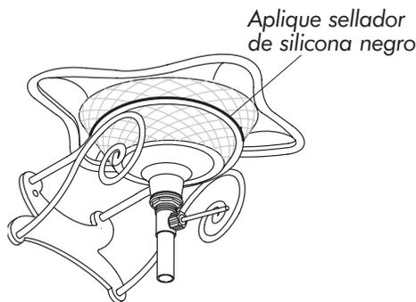
Conecte el montaje del drenaje al sifón.
