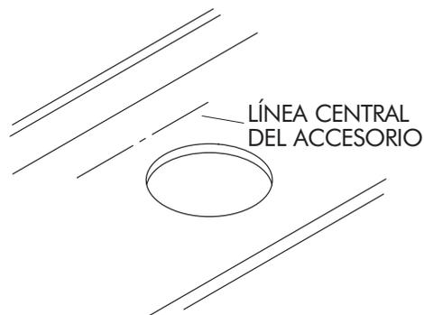
Limpie el mostrador y coloque el lavabo sobre la abertura, de manera que el logotipo de "Kohler" esté orientado hacia atrás. Alinee los bordes del lavabo con la línea trazada o con la cinta adhesiva.
