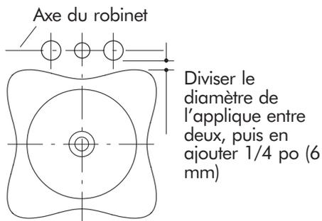
Tracer soigneusement l'axe du robinet sur le gabarit. Choisir l'emplacement le plus adéquat, selon les suivants éléments :
