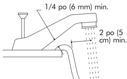
Tracer une ligner sur le gabarit au moins 2 po (5 cm) derrière l'axe final du robinet. Cette ligne déterminera l'emplacement du dossieret.
