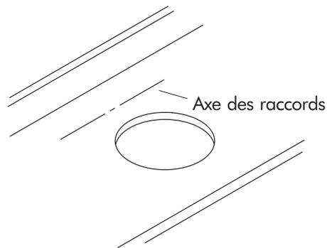
Nettoyer le comptoir et placer le lavabo sur l'ouverture, de façon à ce que le logotype de "Kohler" soit vers le dos. Aligner les bords du lavabo avec la ligne tracée au crayon ou la bordure de ruban-cache.
