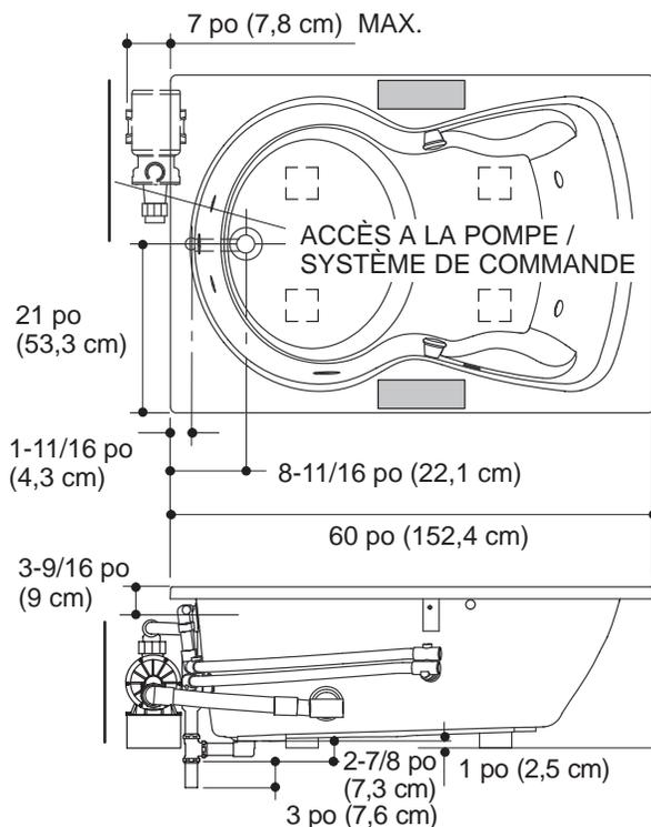
Aucun changement dans les mesures sera nécessaire si connecté avec le drain illustré. (K-7161-AF ou K-7161M-AF)
