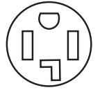
Tomacorriente para 4 hilos (14-30R)
