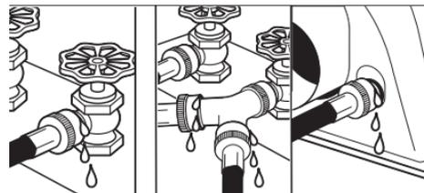
Revise si hay fugas alrededor del conector en "Y", del grifo y de las mangueras.
