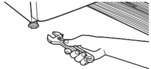
Si la secadora no está nivelada, apuntáela con un bloque de madera. Use una llave para regular las patas hacia arriba o hacia abajo y verifique nuevamente si la secadora está nivelada.
