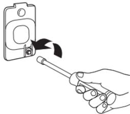
3. Gire el foco en sentido contrario a las manecillas del reloj. Reemplácelo únicamente por un foco para electrodomésticos de 10 W. Vuelva a colocar la cubierta y asegúrela con un tornillo.
