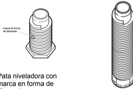
Pata niveladora con marca en forma de diamante
