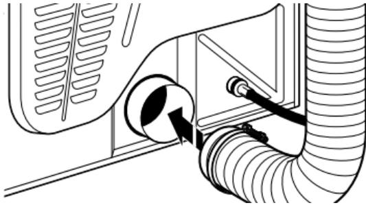
Con una abrazadera de 4" (102 mm), conecte el ducto de escape a la salida de escape en la secadora. Si se conecta a un ducto de escape existente, asegúrese de que el mismo esté limpio. El ducto de escape de la secadora debe encajar sobre la salida de escape de la secadora y dentro de la capota de ventilación. Cerciúrese de que el ducto de escape esté asegurado a la capota de ventilación con una abrazadera de 4" (102 mm).
