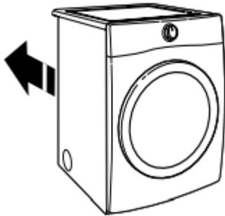
Traslade la secadora hacia su ubicación final. Evite aplastar o retorcer el ducto de escape.
