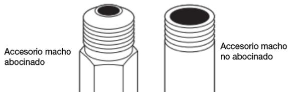
Quite la tapa roja del tubo de gas. Con una llave de tuercas para ajustar, conecte el suministro de gas a la secadora. Use compuesto para unión de tubos en las roscas de todos los accesorios macho no abocinados. Si se usa tubería flexible de metal, asegúrese de que no haya partes retorcidas.
