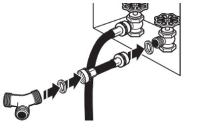
Fije la manguera de entrada de 2 pies (0,6 m) al grifo de agua fría. Enrosque el acoplamiento con la mano hasta que quede asentado en el grifo. Luego sujete el conector en "Y" al extremo macho de la manguera de entrada de 2 pies (0,6 m). Enrosque el acoplamiento con la mano hasta que quede asentado en el conector.
