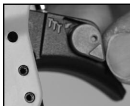
Modo de interruptor en secuencia (el interruptor selector de modo de disparo apunta hacia abajo)
