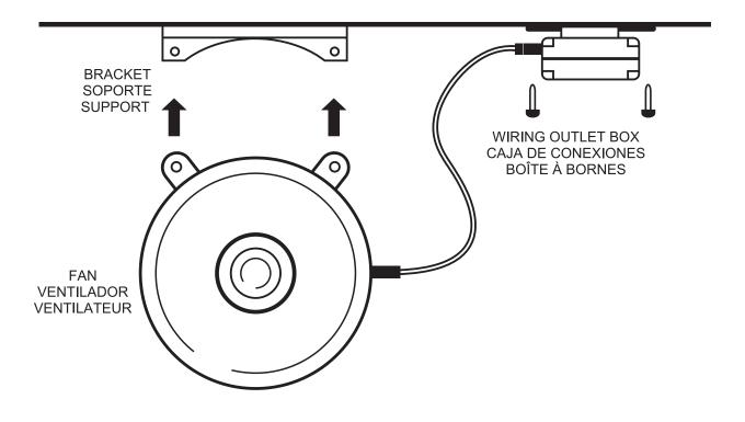
Figure (2). Electrical Wiring / Conexión Eléctrica / Raccordement Electrique.
