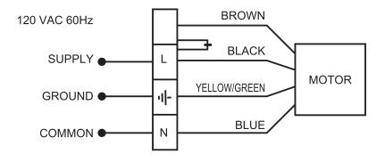
• Motor with Speed Controller / Motor con regulador de velocidad / Moteur avec variateur de vitesse.
