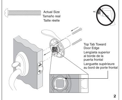
Install Handleset Washer, Screw and Cover Instalación de la arandela, el tornillo y la cubierta del conjunto de la manija Installer la rondelle de la poignée, la vis et le couvercle
