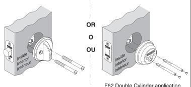
F62 Double Cylinder application Aplicación de cilindro doble F62 Application à cylindre double F62
