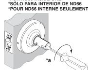
Rotate key 90° and install lever Girar la llave 90° y deslizar la manija sobre el vástago Tourner la clé de 90° et glisser le levier sur l'axe
