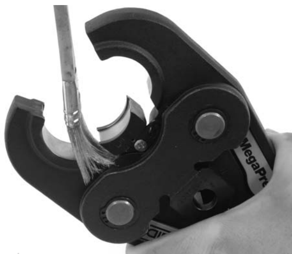
Figure 12 – Nettoyage des axes d'une mâchoire MegaPress
