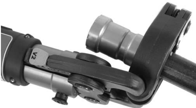
Figura 11B – Las puntas del accionador V2 metidas en las cavidades del aro formando un ángulo con el aro para mayor maniobrabilidad
