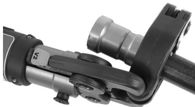
Figure 11B – Engagement à 90° de l'actionneur V2 dans la bague MegaPress en cas de manque de refuite
