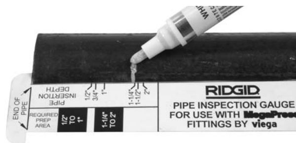
Figure 6B – Repérage de la profondeur d'insertion du tuyau à l'aide d'une jauge de contrôle RIDGID® MegaPress®
