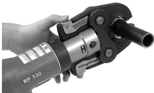
Figura 8 – Apertura de las mordazas MegaPress para colocarlas sobre el acoplador
