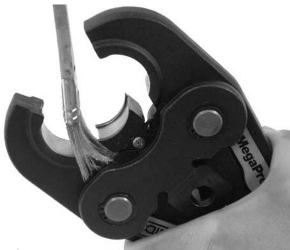
Figura 12 – Limpieza con escobilla de las superficies interiores de una mordaza MegaPress
