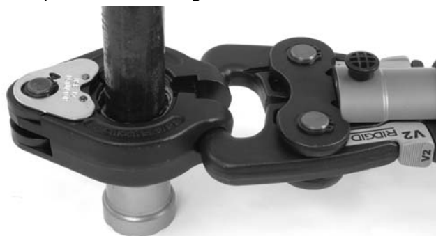
Figure 11A – Engagement des pinces de l'actionneur V2 dans les dépressions de la bague de sertissage
