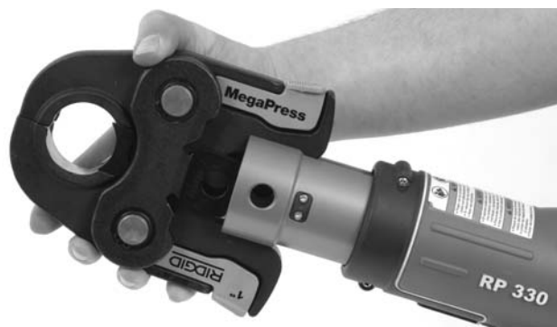
Figure 3 – Retrait d'un outil de sertissage
