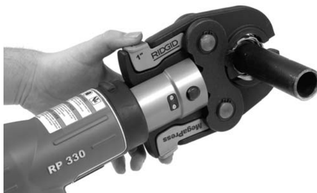
Figure 8 – Ouverture et positionnement des mâchoires MegaPress sur le raccord
