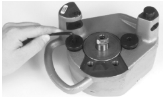
Figura 17 – Instalación del cojinete estabilizador para cobre
