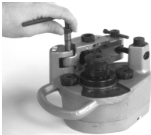
Figure 14 – Retrait de la vis de fixation
