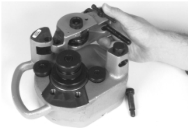
Figure 15 – Retrait de la vis d'avancement
