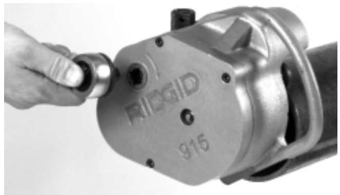
Figura 7 – Trinquete en la entrada de la transmisión
