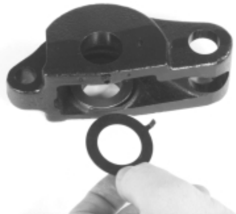
Figura 18 – Manera en que se inserta la arandela con lengüeta
