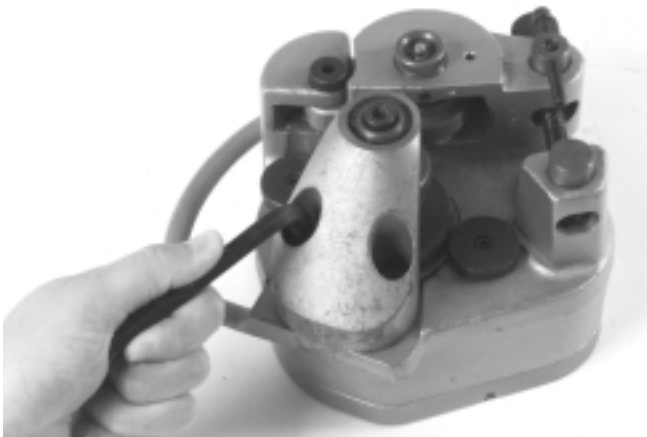
Figura 12 – Instalación de un rodillo de accionamiento
