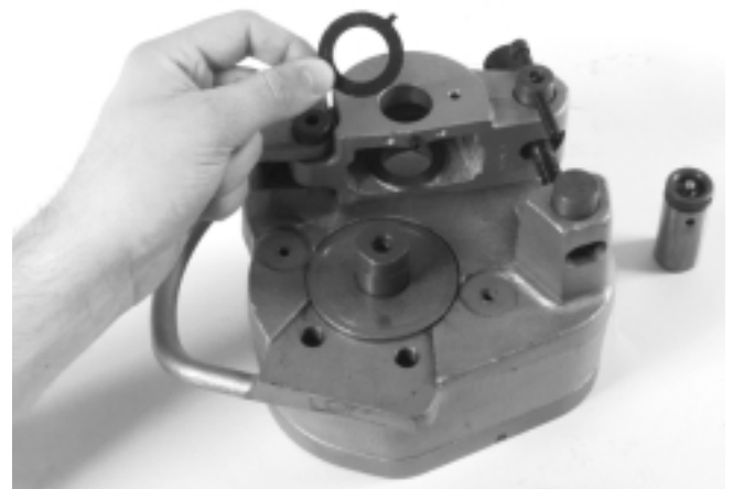
Figure 10 – Positionnement de la rondelle de butée
