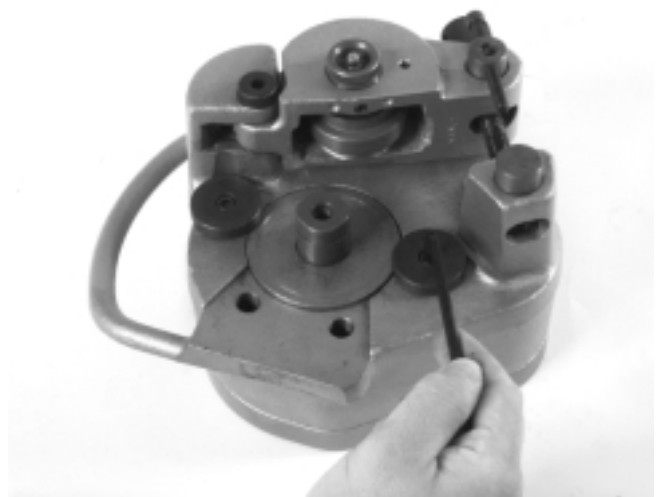
Figure 13 – Installation des stabilisateurs
