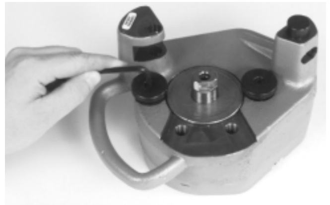
Figure 17 – Installation du stabilisateur pour tuyaux en cuivre
