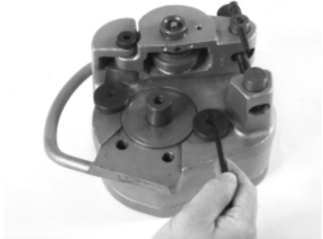
Figura 13 – Instalación de los estabilizadores
