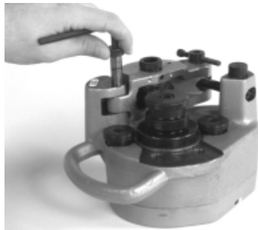
Figura 14 – Extracción del tornillo de tope
