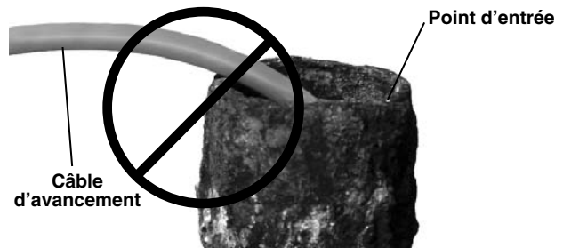
Figure 18 – Éviter d'appuyer contre le rebord
