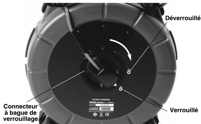
Figure 8 – Verrouillage du connecteur
