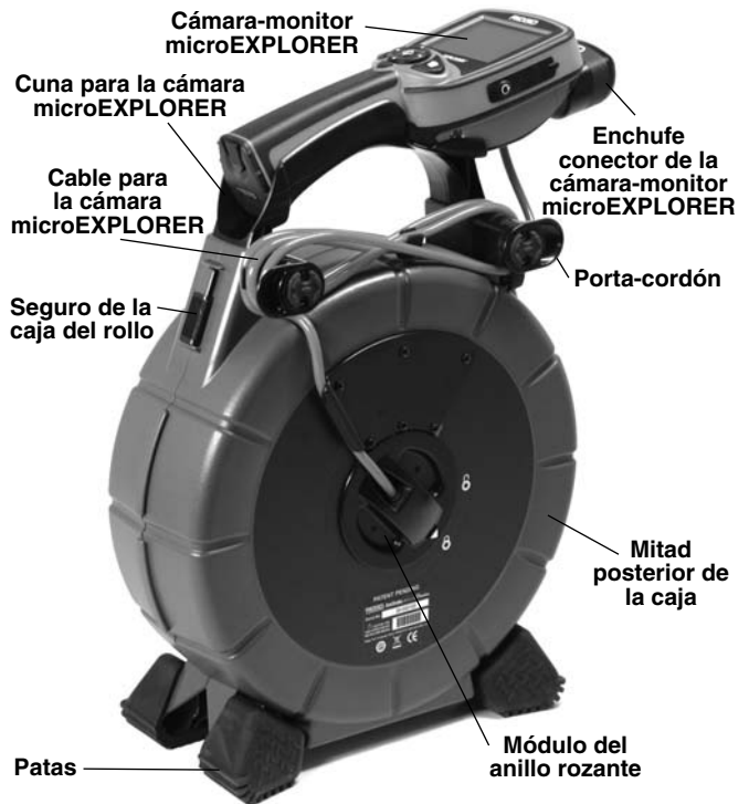
Figura 2 – Vista posterior (configuración cámara microEXPLORER)
