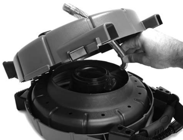
Figure 5 – Positionnement de la tête de caméra
