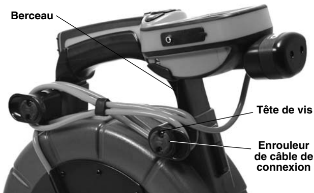
Figure 9 – Berceau et enrouleurs de câble de connexion
