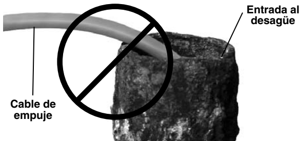
Figura 18 – Evite raspar el cable contra bordes afilados
