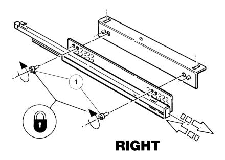
JOIN SIDE MOUNT ANGLES (A) AND (B) AS SHOWN
