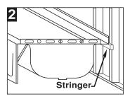
2. Clouer un support de 2" x 4" a une hauteur qui permet au bain de se reposer a neveau, se reposant sur le foam. La support doit faire la pleine longueur du bain. L'INSTALLATION DU BAIN SANS LE SUPPORT DE SOUTIEN ANNULERAS LA GARANTIE.
