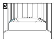
3. Vêrifier le niveau dans toutes les directions. Le plancher doit être plat et de niveau. Une fois que le bain est nivel? attacher le support au mur. Ne pas percer la bride di bain.
