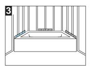
3. Comprobar nivelación en todas las direcciones. Supplemente con cuóas de madera si es necesario. NO SUPLEMENTE debajo del coj'n de anime, es necesario que el soporte de anime descanse obre el piso. El piso debe ser plano y nivelado. Una ve que la tina sea nivelada, sujetar permanentemente el listón a la cabeza del perno de fijación. NO sujetar a travês del borde de la tina.
