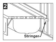
2. Clavar con tachuelas un listón del 2" x 4" en una altura que permita que la tina quede nivelada, descansando sobre el cojín soporte de anime. El listón debe abarcar la longitud completa de la tina. LA INSTALACIÓN DE LA TINA SIN UN ISTÓN A TODO LO LARGO DE LA LONGITUD DEL SOPORTE ANULA LA GARANTÍA.
