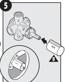
Slide Stop Tube (**B**) onto valve. Deslice el tubo de cierre (**B**) sobre la válvula. Faire glisser le tube d'arrêt (**B**) sur la soupape.
