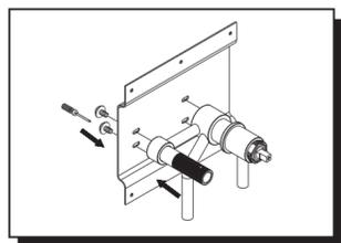
2. Secure the valve to metal board with screws included. Sujete la válvula a la placa metálica con los tornillos provistos. Fixer le robinet au panneau de métal à l'aide des vis comprises.
