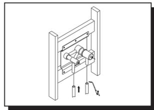
4. Solder water supply tube to inlet port. Suelde el tubo de alimentación de agua a la toma de agua. Souder le tuyau d'alimentation en eau à l'orifice d'entrée.
