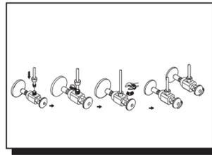
9. Apply pipe tape onto threads of the water supply. Tighten the hose onto water supply. Aplique cinta de plomería en la rosca del suministro de agua. Apriete la tubería flexible en la tubería de abastecimiento.
