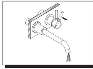
10. After installing faucet, remove aerator and turn on water to remove any left over debris. Re-assemble aerator. Después de instalar el grifo, remueva el aireador y abra el paso del agua para remover cualquier residuo. Vuelva a armar el aireador. Après avoir terminé l'installation du robinet, enlever le brise-jet, puis ouvrir le robinet pour que l'eau évacue tout débris pouvant se trouver à l'intérieur. Réassembler le brise-jet.
