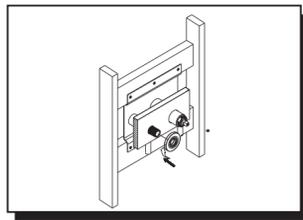
5. Install spout trim ring onto spout shank. Instale el anillo ornamental del grifo en el vástago del vertedor.
