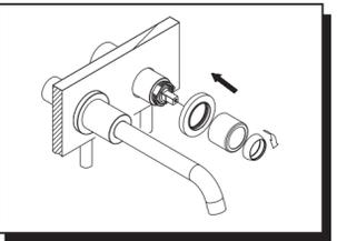
7. Install the handle trim ring, sleeve and cap onto handle valve. Instale el capuchón ornamental de la manija, la manga y la tapa en la válvula de la manivela. Installer l'ornement circulaire de manette, le manchon et le capuchon sur le robinet à manette.
