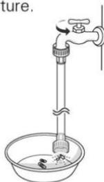
4 Raccordez les tuyaux aux orifices d'admission d'eau, puis en serrant encore 2/3 de tour avec une pince.
