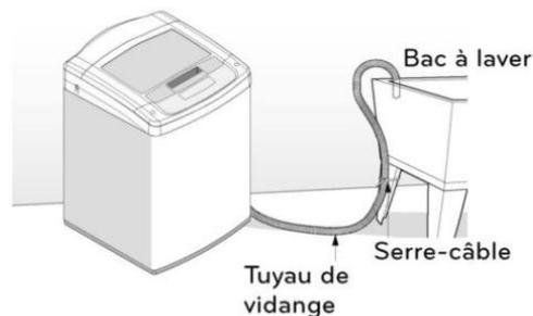
Tordre l'extrémité du tuyau d'évacuation selon la forme désirée et la faire reposer sur le bord du bac à laver. Utiliser un serre-câble pour maintenir le tuyau d'évacuation en place.
