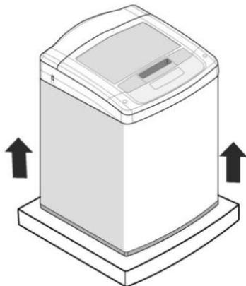
Lorsque vous extrayez le lave-linge de la base du carton, veillez à retirer le support de cuve situé au milieu de la base du carton. Si vous devez déposer la machine à laver sur le sol pour enlever les matériaux d'emballage de la base, protégez toujours les parties latérales de l'appareil et posez-le précautionneusement sur le côté. Ne déposez PAS la machine à laver sur l'arrière ni sur l'avant.
