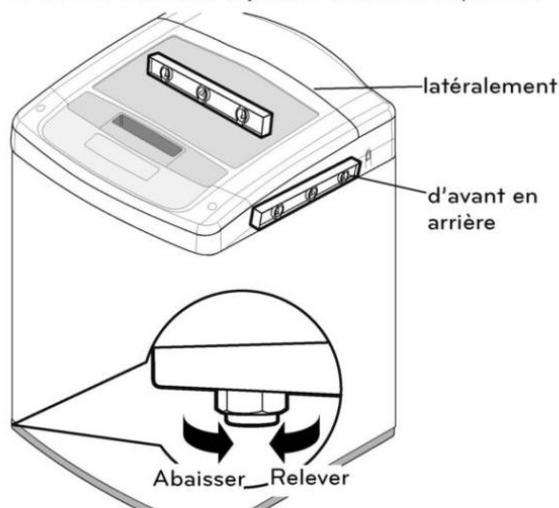
Si le lave-linge n'est pas à niveau, ajustez pieds de mise à niveau. Tournez dans le sens des aiguilles d'une montre pour relever la machine, et dans le sens inverse pour l'abaisser.
