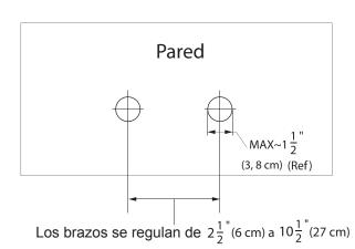
Brazo a utilizar para montaje en pared. No es necesario para tuberías de alimentación no empotradas.
