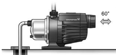
Fig. 3 Dégagement minimal derrière la pompe
