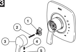
Fixez le bouton de réglage de température (1) avec la vis (2). Installez le couvercle de réglage de température (3) et fixez-le avec la vis de calage (4). Installez le capuchon (5).
