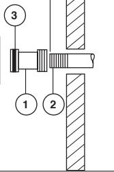
**Instalación del tubo de hierro****Instalación del tubo de salida de agua del easy-on universal para bañeras**
