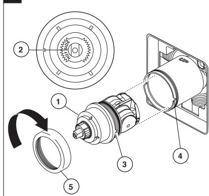
Gire el cartucho (1) de manera que las palabras 'HOT SIDE' (LADO CALIENTE) (2) aparezcan en la izquierda. Introduzca el cartucho en la válvula. Asegúrese que la guía (3) en el cartucho esté totalmente encajada en la muesca del cuerpo de latón (4). Deslice la tuerca tapa (5) sobre el cartucho y enrosque en el cuerpo de la válvula. Apriete a mano bien.
