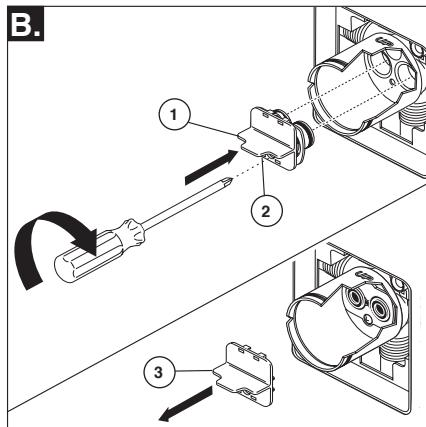
Introduzca el adaptador (1) en la válvula. Asegúrese que el adaptador estén correctamente colocados dentro de los orificios en la base de la válvula. Fije el adaptador con el tornillo (2) suministrado con el adaptador. Quite el retenedor (3) del adaptador.
