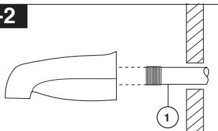
**Installation à l'aide d'un tuyau de fer**
