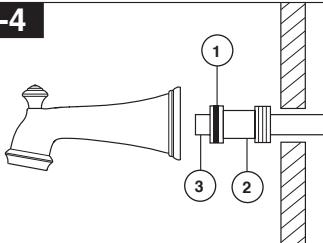
**Installation à l'aide d'un tuyau de cuivre brasé**
