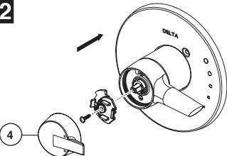
Fixez le bouton de réglage de température (1) avec la vis (2) et, accrocher avant ou poussant fermement sur calez le couvercle (3) sur bouton avant de engageant arrière bouton (1).
