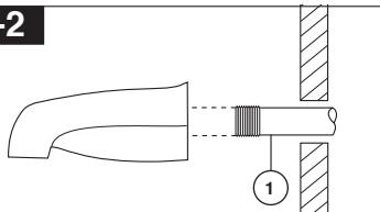
**Instalación de la tubería de Hierro**
