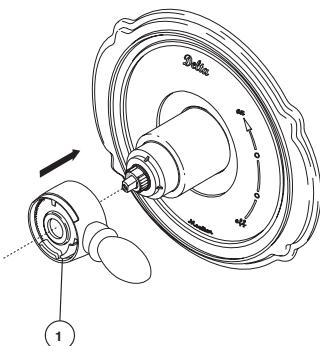
Instale la manija de control del volumen (1) con la palanca hacia la derecha, luego gírela a la posición abierta. NO FIJE CON TORNILLO.
