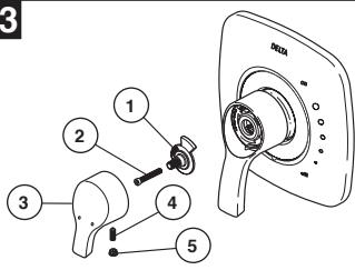
Fije la perilla para el control de la temperatura (1) con un tornillo (2). Instale la cubierta del control de temperatura (3) y fije con un tornillo de ajuste (4). Instale la cubierta del botón (5).
