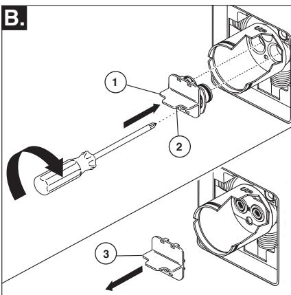
Introduisez l'adaptateur (1) dans le corps de la soupape. Assurez-vous que les joints toriques sont positionnés correctement dans les trous à la base du corps. Fixez l'adaptateur avec la vis (2) se trouvant dans celui-ci. Retirez la pièce de retenue (3) de l'adaptateur.
