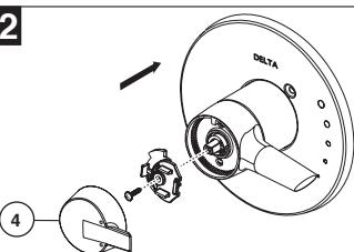
Fije la perilla para el control de la temperatura (1) con un tornillo (2). Gancho (3) delantero coloque la perilla para el control de couverture (4) encima de perilla (1) antes de la participación parte trasera instantánea (5).
