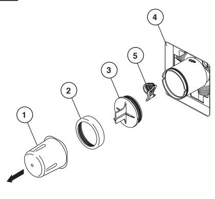
**Interrompez l'arrivée d'eau.** Enlevez le couvercle (1), l'écrou à portée sphérique (2) et le capuchon d'essai (3) du corps. Si vous n'installez pas l'appareil dans une paroi mince, vous pouvez retirer le protecteur (4) complètement. Si l'écran (5) est en place, enlevez avant d'installer la cartouche.
