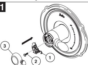
Fije la perilla para el control de la temperatura (1) con un tornillo (2) coloque la perilla para el control de cubierta (3) encima de perilla(1).
