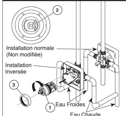
Dans le cas d'une installation dos à dos ou inversée (eau chaude à droite et eau froide à gauche) : Tournez la cartouche (1) de sorte que la mention « HOT SIDE »(2) se trouve du côté droit. Installez la cartouche en vous assurant que l'ergot est parfaitement engagé dans la rainure du corps en laiton. Faites glisser l'écrou à portée sphérique (3) sur la cartouche et vissez-le sur le corps. Serrez à la main fermement.
