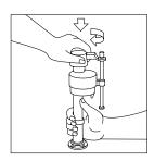
Remettre le chapeau en place en engageant les oreilles et en tournant le chapeau de 1/8 de tour dans le sens des aiguilles d'une montre.
