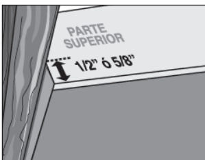
Figura 1 Las patas metálicas posicionan la cámara de pared de modo que quede el espacio mínimo entre ésta y el piso.
