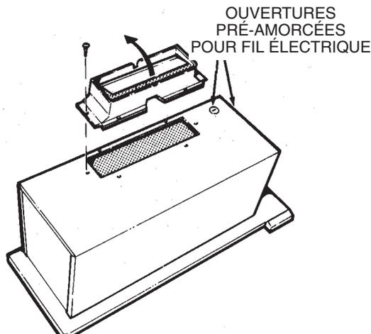
Utilisez les deux (2) vis (fournies) pour assembler l'adaptateur/volet au caisson. Le volet de l'adaptateur doit ouvrir dans la direction indiquée par la flèche.
