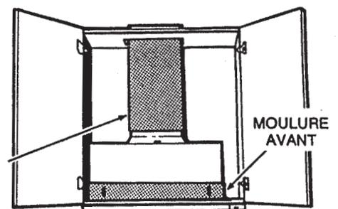
Finir l'installation des conduits à partir de la hotte jusqu'à l'extérieur, en utilisant un capuchon de toit ou un coude et un capuchon de mur. Sceller tous les joints avec du ruban adhésif en toile. Des tablettes peuvent être installées si elles sont découpées de façon à ne pas toucher aux conduits.
