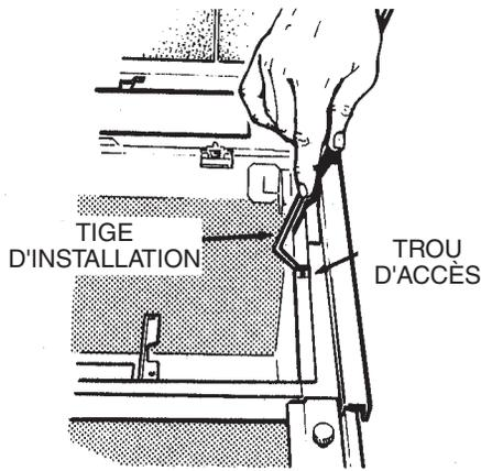
Insérer l'extrémité courbée de la tige d'installation dans le trou d'accès du caisson.
