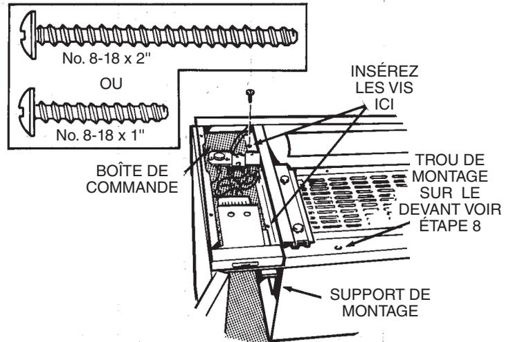
Insérer deux (2) vis, courtes ou longues, telles qu'appropriées, à travers la boîte de commande et dans l'autre support de montage. Ne pas serrer complètement les vis.
