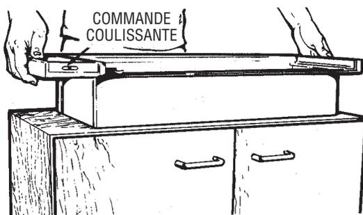
Descendre le caisson avec soin dans l'ouverture de l'armoire. La commande coulissante doit se trouver à l'avant.
