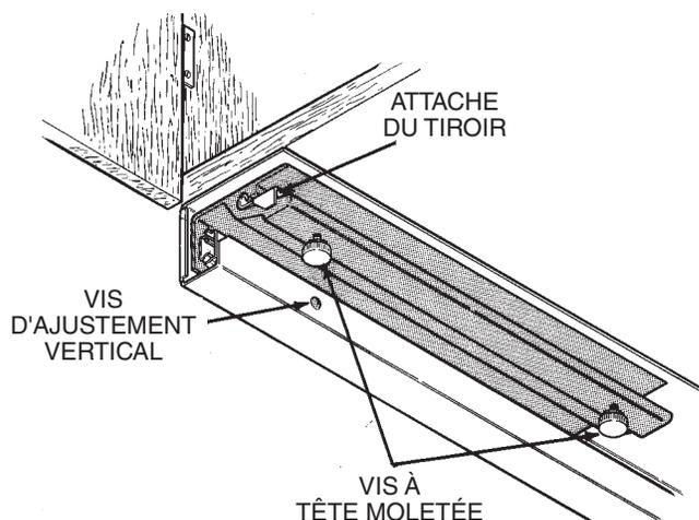
Chaque coulisse de tiroir est munie d'une vis pour le réglage éventuel de la hauteur de la mouleure du tiroir. La vis de réglage vertical permet d'ajuster la mouleure du tiroir à la même hauteur que la mouleure de la boîte de commande.
