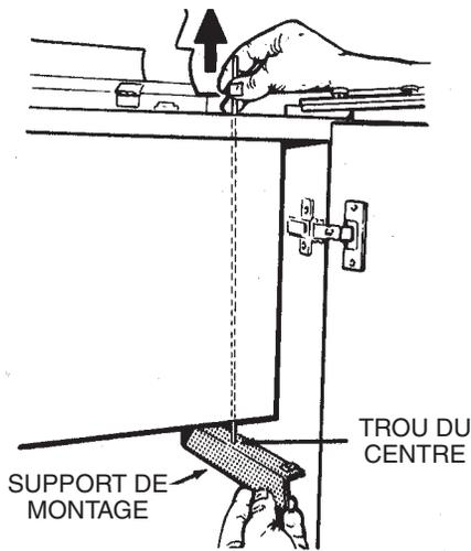
Choisir le support de montage avec le trou du centre. Suspendre le support par la tige, par le trou du centre, tel qu'illustré. Tirer le support vers le haut entre l'armoire et le caisson.
