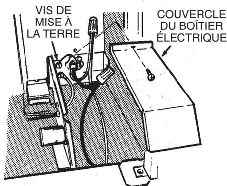
Enlever le couvercle du boîtier électrique. Fixer le fil d'alimentation électrique à la hotte en utilisant le connecteur approprié. Connecter le fil noir au fil noir, le fil blanc au blanc et le fil vert ou dénudé à la vis de mise à la terre. Réinstaller le couvercle du boîtier électrique.
