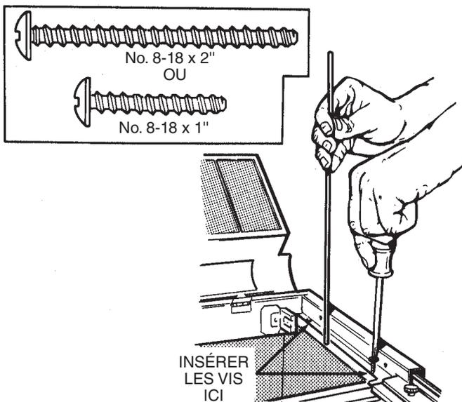
Tenir le support de montage en place avec la tige. Deux ensembles de vis sont fournis. Utiliser les vis courtes pour les armoires à base lisse ou les vis longues pour les armoires à base en retrait. Insérez deux (2) vis à travers le caisson et dans le support de montage. Ne pas serrer complètement les vis.
